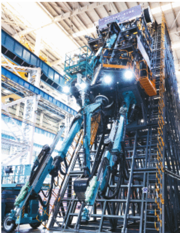
斜井开挖钻护一体化装备突破斜井隧道施工长期存在的技术瓶颈。长沙晚报通讯员 梁超 景煜煜 供图
